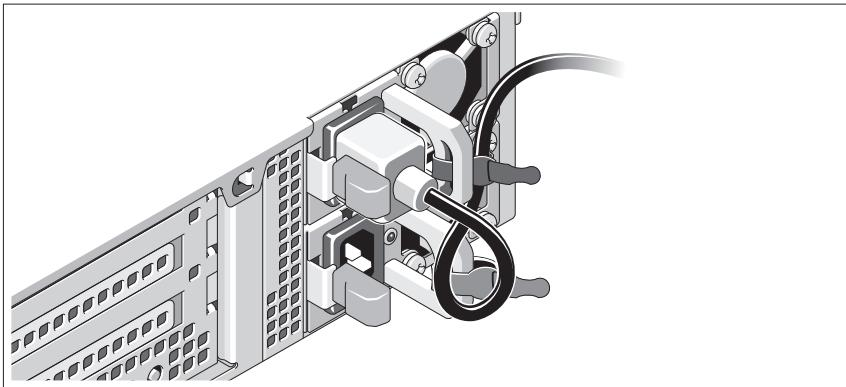
如图所示，将系统电源电缆弯曲成一个环状，并使用所提供的腕带将其固定到支架。将电源电缆的另一端插入接地的电源插座或单独的电源，如不间断电源设备 (UPS) 或配电装置 (PDU)。
