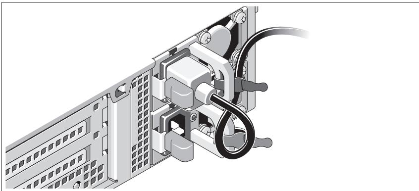
システムの電源ケーブルをループ状に曲げ（図を参照）、付属のストラップでプラケットに固定します。電源ケーブルのもう一方の端をアースされた電源コンセントまたは UPS（無停電電源装置）や配電装置（PDU）などの電源に接続します。
