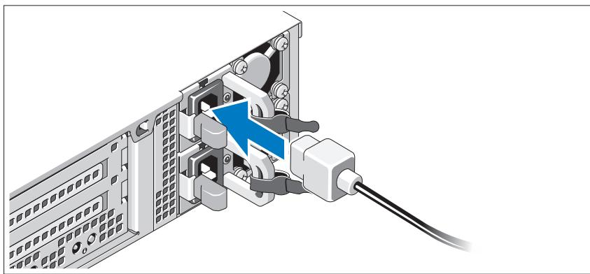
システムの電源ケーブルをシステムに接続し、モニタを使用する場合は、モニタの電源ケーブルをモニタに接続します。
