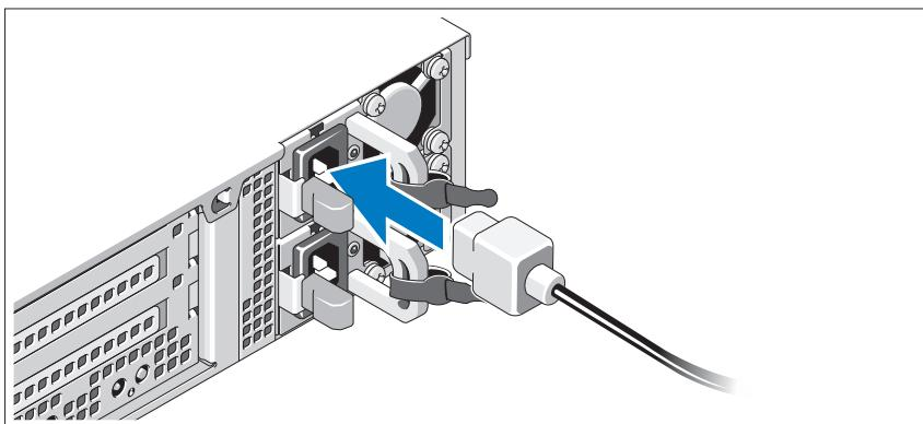
Hubungkan kabel daya sistem ke sistem dan, jika monitor digunakan, hubungkan kabel daya monitor ke monitor.
